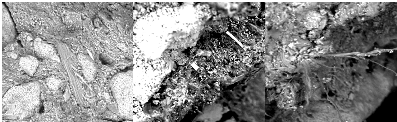
Figura 1. Fibre di amianto di tipo crisotilo all'interno di linoleum.
